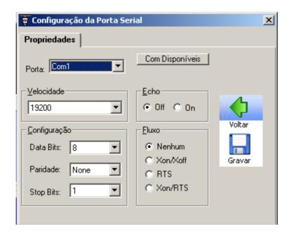
Ex.: Para centrais Intelbras analógicas Velocidade 4800 ou 9600 8 bits Sem Paridade Stopbits 2
